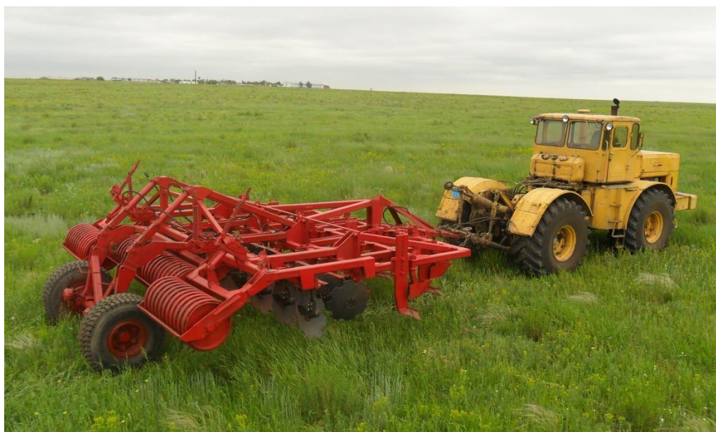
Рисунок 2 – Орудие для обработки залежных земель в агрегате с трактором К-701
