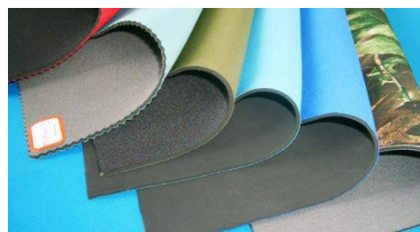
Рисунок 1 – Структура и внешний вид неопрена
