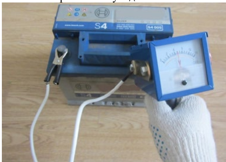
Сурет 3. Жүктеме кезінде батарея зарядын өлшеу
