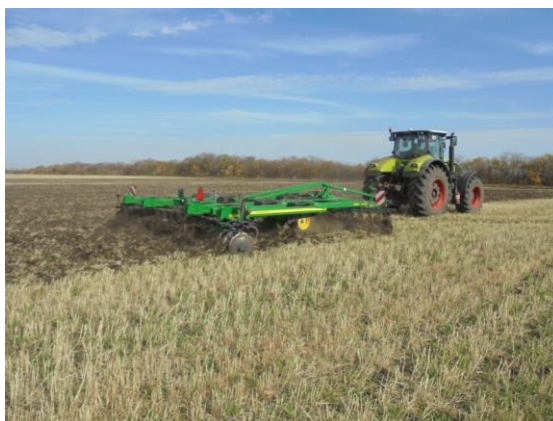
Рисунок 1 – Глубокорыхлитель дисковый «John Deere» модели 2720 в агрегате с трактором фирмы «Claas» модели AXION 950 в работе
