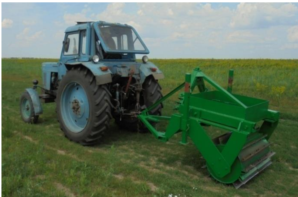
Рисунок 1 – Макетный образец орудия для измельчения сидератов в рабочем положении в агрегате с трактором МТЗ-80
