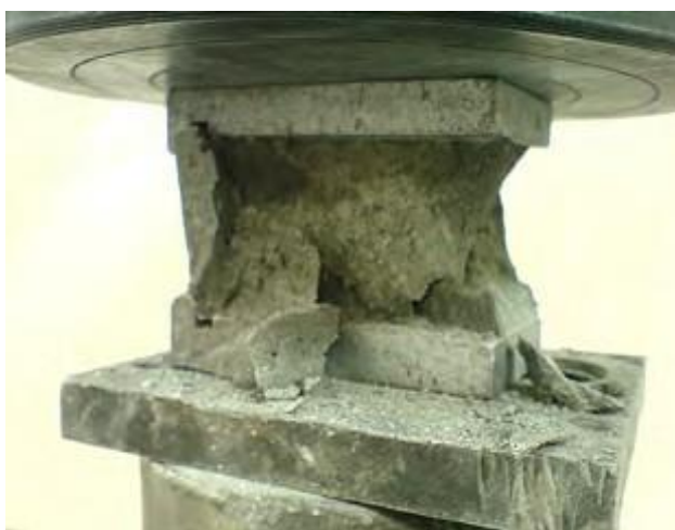
Сурет 1 - Сығымдау сынағынан кейін органикалық талшығы жоқ бетон үлгісі
