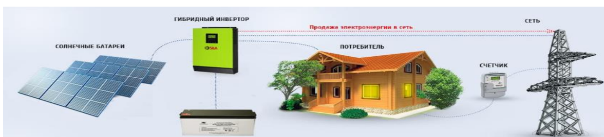
Рисунок 3 - Гибридные солнечные электростанции
