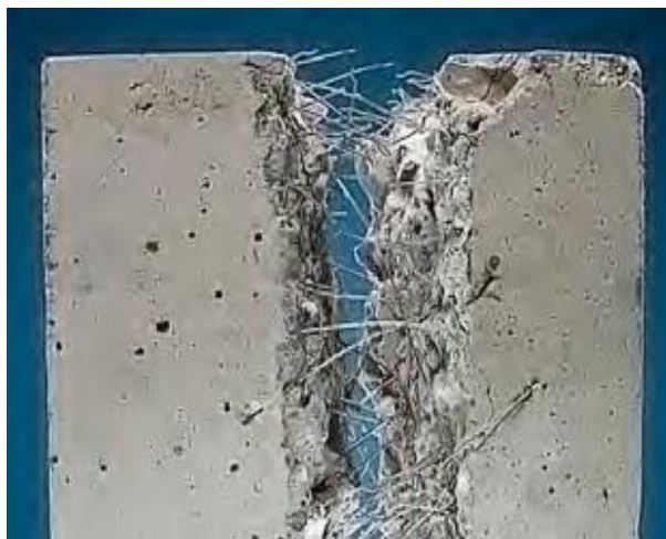
Сурет 2 - Сығымдау сынағынан кейін органикалық талшықтарымен нығайтылған бетон үлгісі
