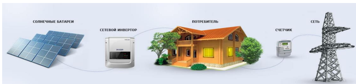
Рисунок 1 - Сетевые солнечные электростанции
