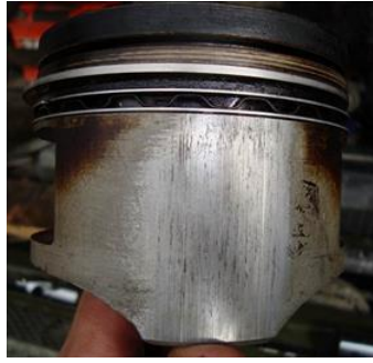
1-сурет - Поршень юбкасының тозуы
