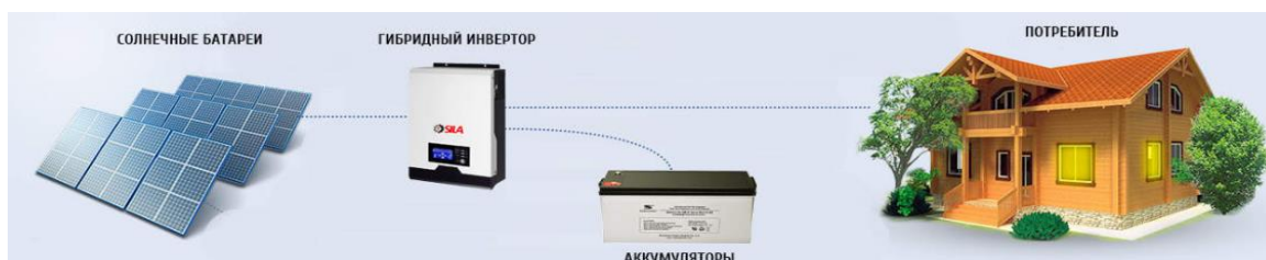
Рисунок 2 - Автономные солнечные электростанции
