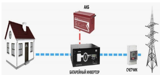
Рисунок 4 - Системы резервного электроснабжения
