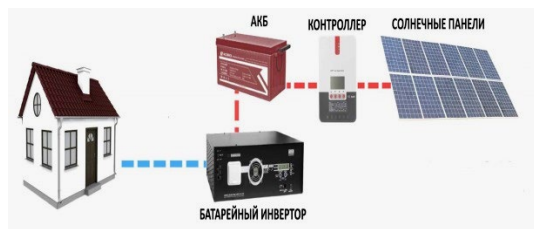
Рисунок 2 - Автономные фотоэлектрические установки
