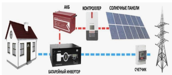
Рисунок 3 - Гибридные фотоэлектрические установки
