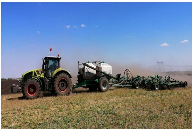
Рисунок – Посевной комплекс «Кузбасс» модели ПК-12,2 в агрегате с трактором фирмы «Claas» модели AXION 950 в работе
