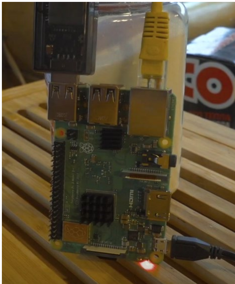
Рисунок 2.1 – Raspberry Pi3 B+ с подключенными ZigBee координатором (сверху слева) и LAN кабелем (желтый).
