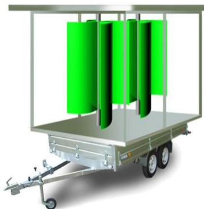
**Рисунок 2 – Передвижная ветроэлектростанция**
