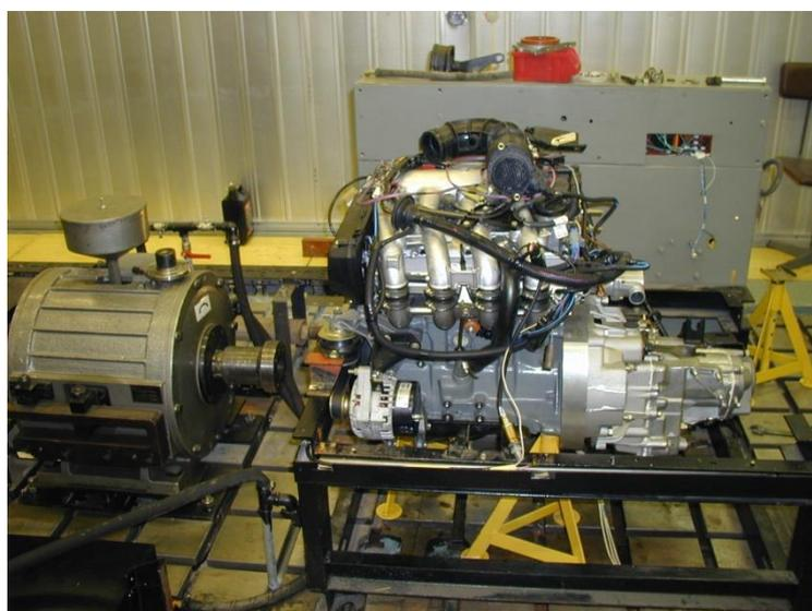
**Рис. 2. Установка СГУ на двигатель внутреннего сгорания (стенд, АВТОВАЗ)**
