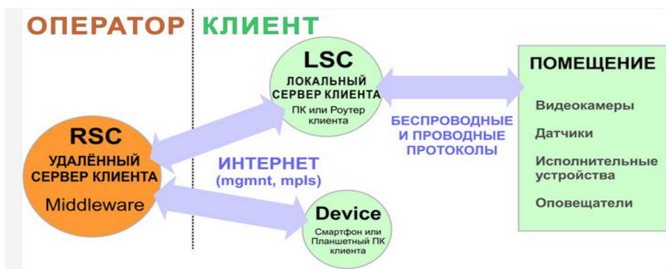
Рисунок 3. Взаимодействие основных элементов системы
